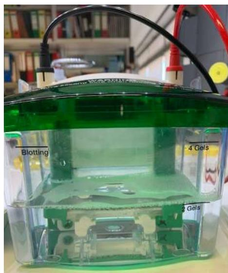
**Figure 43**, électrophorèse en cours sur une clôture spécifique pour les gels de polyacrylamide. Observez les différentes caméras que l'instrument possède pour séparer les gels et les immerger dans les différents tampons pour effectuer un effacement des protéines de manière optimale.
