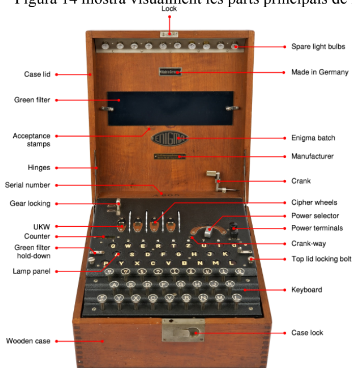
Figura 14. Parts de la màquina enigma
